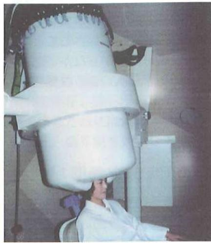
東京電機大学で開発した120チャンネルの脳磁計。脳から自発的に発生している微弱な磁気を瞬時に計測して、脳の活動している場所を知ることができる
