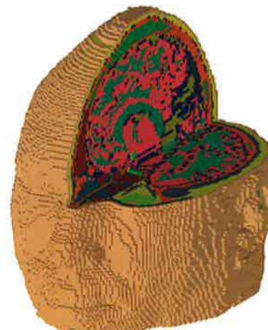
図9 電磁場解析用標準人体モデルの頭部.
