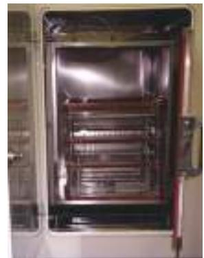
図2.電磁界曝露装置をセットしたCO<sub>2</sub>インキュベーター
