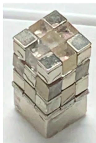
図3. 小型磁石の組み合わせによる最適化磁石形状の開発。磁気モーメントが存在する部分は永久磁石、磁気モーメントが存在しない部分はアクリルで形成。
